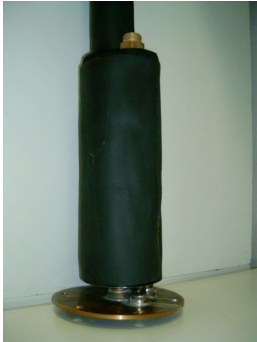
2. ábra A beépített hőcserélő
